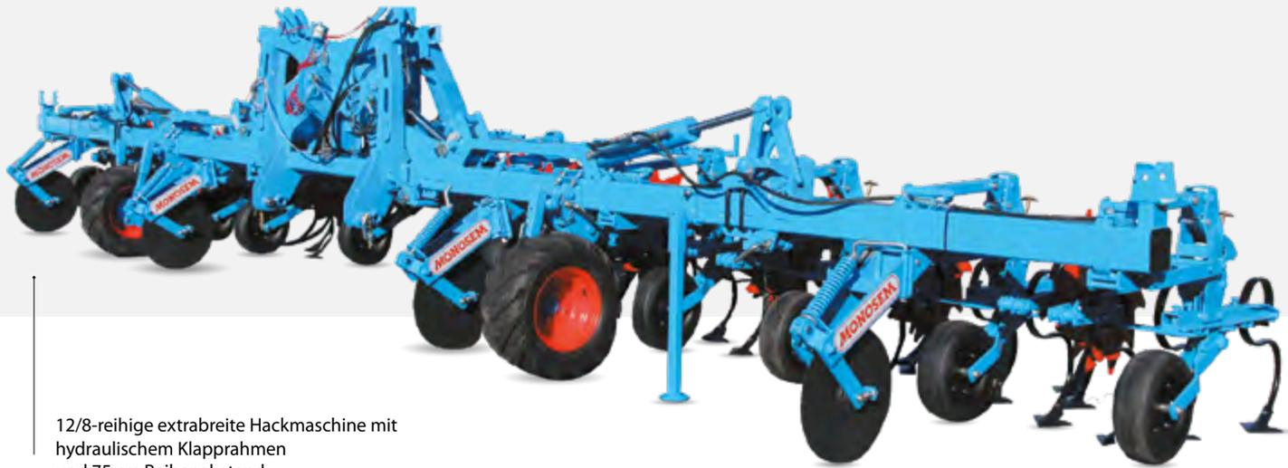
12/8-reihige extrabreite Hackmaschine mit hydraulischem Klapprahmen und 75 cm Reihenabstand
