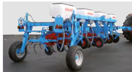
8-reihige Hackmaschine mit TIP 5"-Rahmen und 70 cm Reihenabstand in Transportstellung
