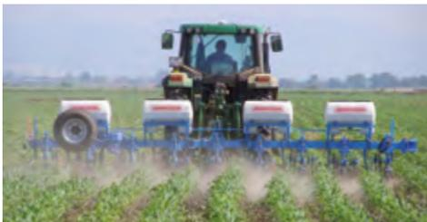
8-reihige Hackmaschine mit TIP 5"-Rahmen und 70 cm Reihenabstand
