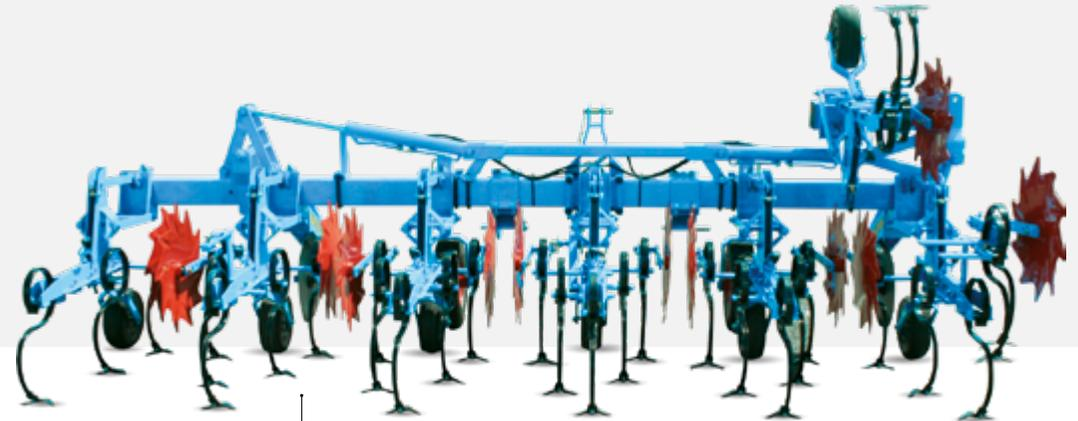
8-reihige Hackmaschine mit hydraulischem TIP 5"-Klapprahmen und 75 cm Reihenabstand
