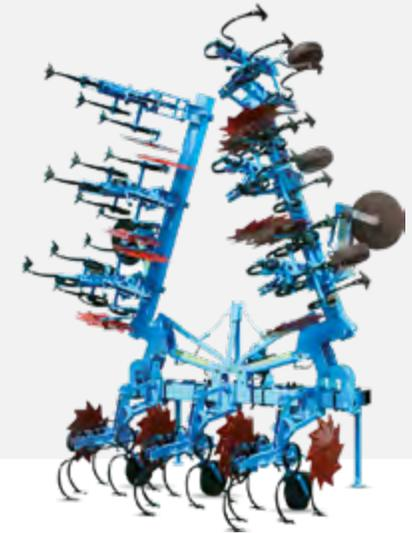
8-reihige Hackmaschine mit hydraulischem TIP 5"-Klapprahmen und 75 cm Reihenabstand
