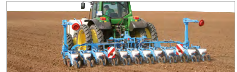
12-reihige Sämaschine MECA V4 mit Doppelbalken-Klapprahmen
