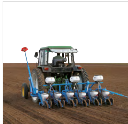
6-reihige Sämaschine MECA V4 mit starrem Einzelbalken-Rahmen und Microsem
