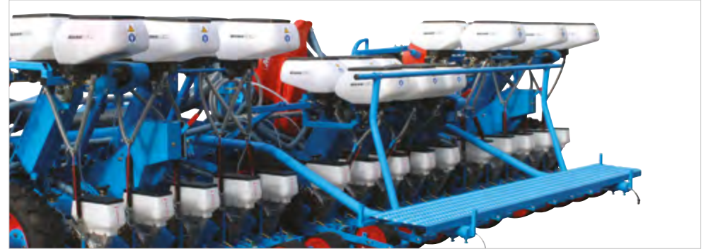
Am Radblock angebrachtes Wechselradgetriebe Mindestreihenabstand (1): 43 cm
