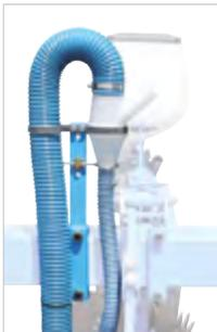
Vor jedem Element montierte Zyklonabscheider stellen sicher, dass der Dünger per Schwerkraft zu Boden fällt und weniger Staub durch den Luftstrom entsteht.
