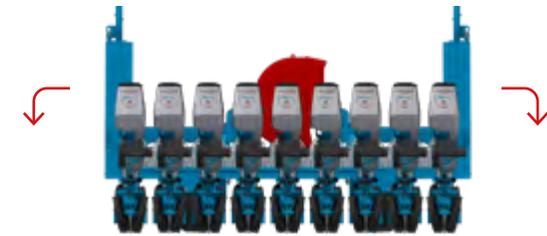
Ausklappen der Flügel
