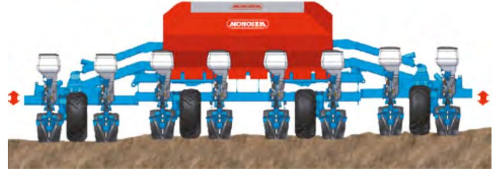
Unsere Klapprahmen mit Doppelbalken und schwimmend gelagerten TFC-Rahmen sorgen mit ihren separaten Seitenflügeln und Radblöcken für eine perfekte Boden Anpassung.
